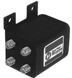
Der von mir verwendete Schalter hat Positionsanzeigekontakte und ich habe sie über einen gemeinsamen 4,7 kOhm Strombegrenzungswiderstand, der für 5 mA Strom mit einer Betriebsspannung von 28 VDC gewählt wurde, mit LED-Anzeigen verbunden. Ich habe den Widerstandswert experimentell bestimmt, da die vorverdrahteten LEDs, die ich auf Lager habe, bereits Spannungsabfallwiderstände für Nennbetriebe von 12 V enthalten.
